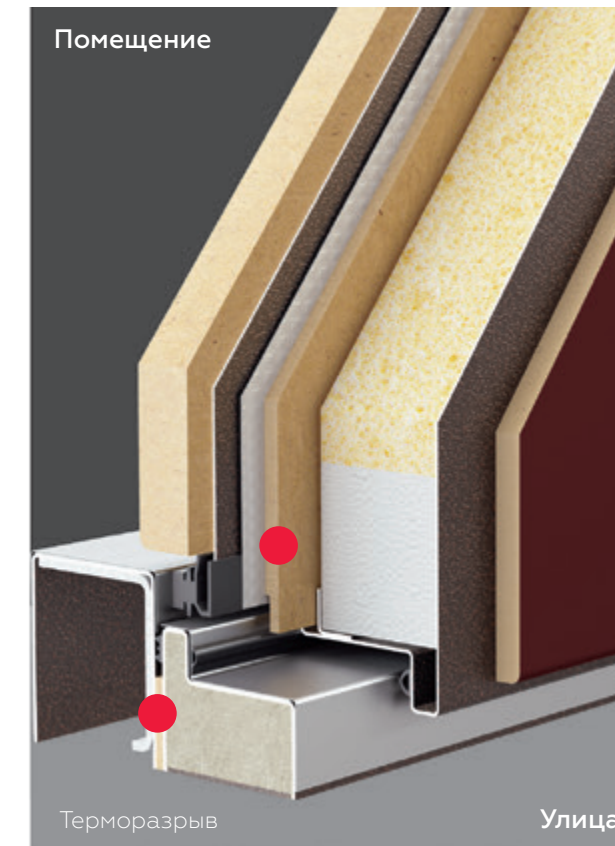
Один контур терморазрыва в стальной двери
